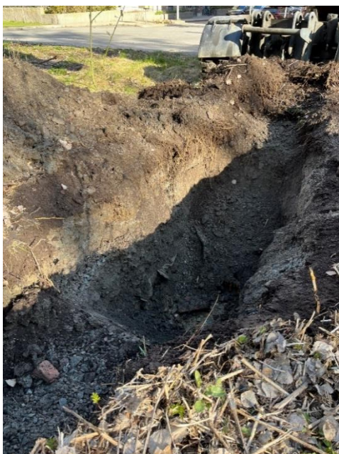
Figur 6. Provgroppsgrävning i 23VM01 med inslag av tegel och asfalt ned till drygt 1 m. Naturlig morän från 1,1 m djup (2023-05-10).
