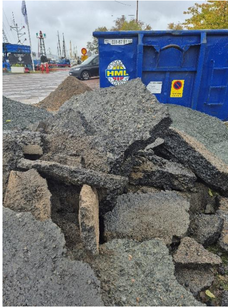
Figur 1. Översiktsbild av asfaltsmassor som provtagits. Asfalt klassas som Ej tjärasfalt <70 mg/kg.
